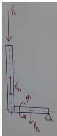
Figura 2 - Diagrama de forças simplificado
