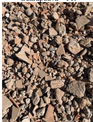
Figura 1 – Agregados reciclados comercializados na Usina de Reciclagem de Entulho de Guarapuava – PR
