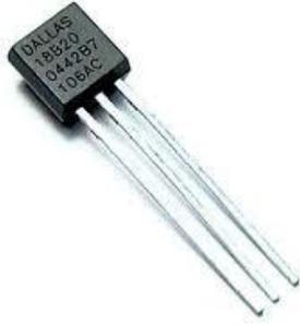
Figura 4. Sensor de temperatura DS18B20
