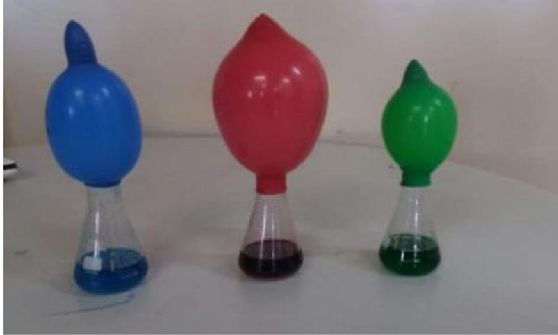
No intuito de enfatizar a proporção estequiométrica no processo reacional, realizou-se o experimento 2, o qual possibilitou verificar claramente que diferentes quantidades de reagentes produziram diferentes quantidades de produto (Figura 2).
