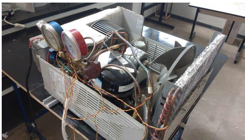
Figura 2: Experimento aplicado de Termodinâmica - Sistema de ar condicionado
