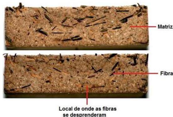
Figura 13. Aspecto da fratura do ensaio do corpo de prova do compósito com 3% de piaçava.
