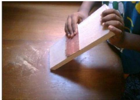
Figura 5. A utilização da lixa no tratamento da superfície do corpo de prova.
