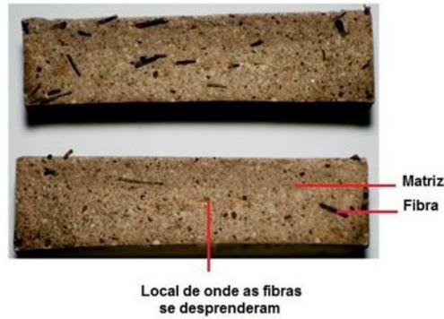
Figura 12. Aspecto da superfície de fratura do compósito com 1% de piaçava.
