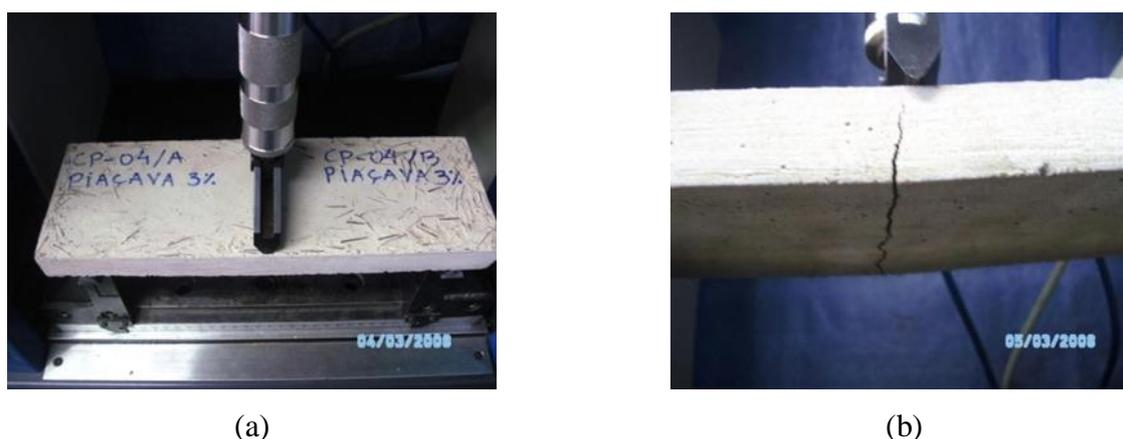
Figura 9. O ensaio do compósito com 3% de piaçava, em (a) mostra o início do ensaio e em (b) a trinca que ocorreu durante ensaio.
