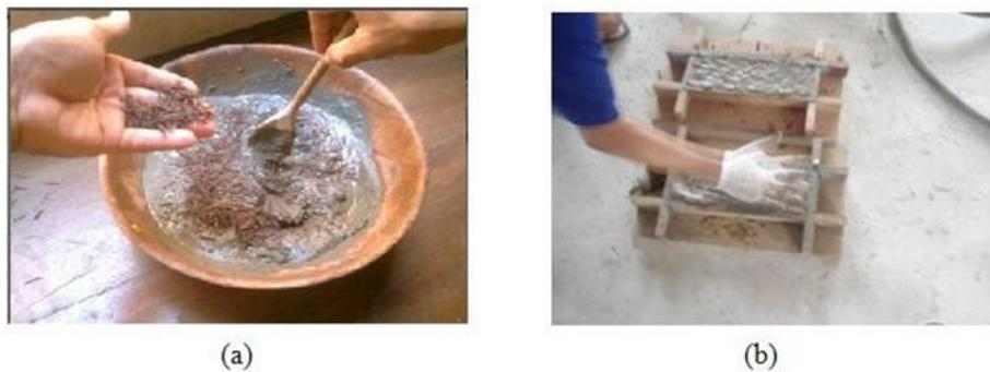
Figura 3. (a) Mistura dos componentes: fibras, água, areia e cimento e (b) processo de moldagem com a inserção da mistura no molde de madeira.
